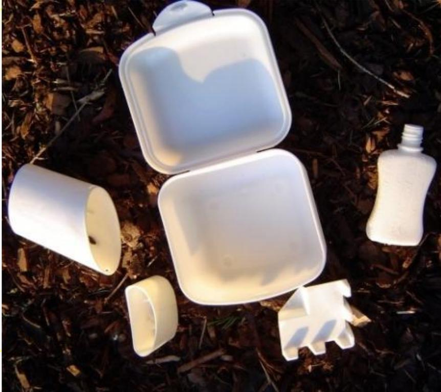
**ARBOBLEND®** besteht je nach Rezeptur z. B. aus verschiedenen Biopolymeren wie beispielsweise Lignin, Polylactid, Polyhydroxybuttersäure, Stärke, Naturharzen, natürlichen Fettsäuren, Wachsen, Cellulose, Green-PE, Bio-PA und Additiven.
