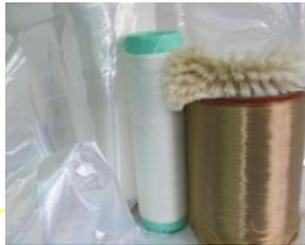
Spezielle ARBOBLEND® Rezepturen lassen sich zu Filamenten unterschiedlicher Titer Schmelzspinnen.
