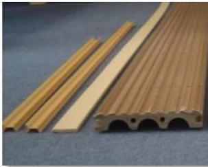
Extrusion von Profilen, z.B. von unterschiedlichen Leisten.
