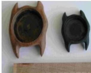
Spritzgießen von ARBOFORM® mit anschließender Pyrolyse ergibt Kohlenstoffformteile (99,9% C-Gehalt) mit elektrischer Leitfähigkeit und sehr hoher Wärmeformbeständigkeit.
